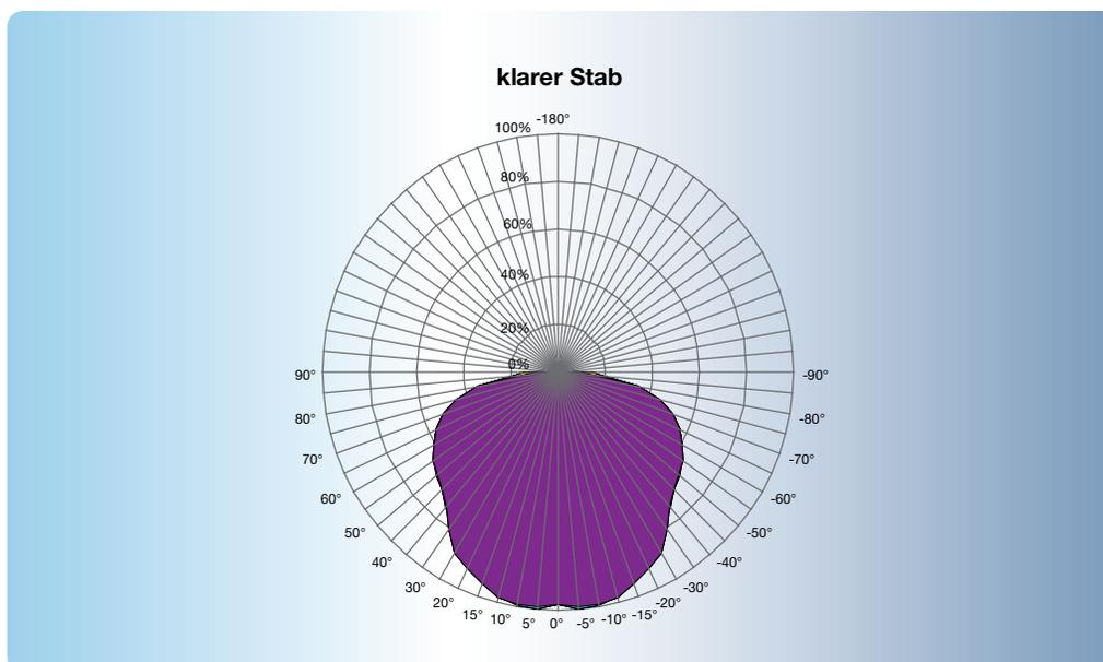
Unterhalb eines Winkels von etwa 70° wird seitlich auf den Lichtfühler fallendes Licht kaum gedämpft. Licht, das im Winkelbereich von 85 – 90° auf ihn fällt, wird jedoch sehr stark gedämpft (Totalreflektion am Glasstab).
