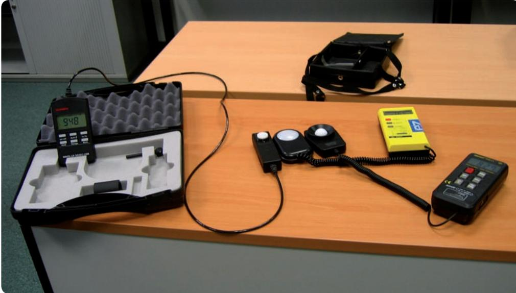
In dem obigen Bild zeigt das linke Messgeräte 948 lx, das mittlere (gelb) 765 lx und das rechte Messgerät 827 lx an. Die Unterschiede können dabei – abhängig davon, ob es sich um Tageslicht, Kunstlicht oder Mischlicht handelt oder ob sich die Geräte im Schattenbereich befinden oder direkt von der Sonne bestrahlt werden – größer oder kleiner sein.
