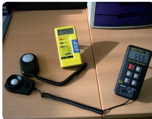
Am gleichen Messort zeigen, bei unterschiedlichen Beleuchtungsverhältnissen durch das einfallende Tageslicht mit leichter Schattenbildung, beide Geräte im linken Bild deutlich unterschiedlichere Werte und im rechten Bild nahezu den gleichen Wert an.
