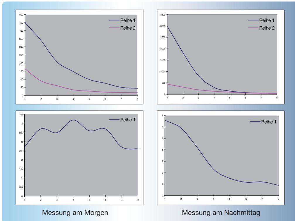
Wie aus den Diagrammen zu sehen ist, liegt am Morgen (keine direkte Sonneneinstrahlung in den Raum) der Quotient im Bereich zwischen 2,7 und 4,2, am Nachmittag hingegen (direkte Sonneneinstrahlung in den Raum) zwischen 0,9 und 6,6.
