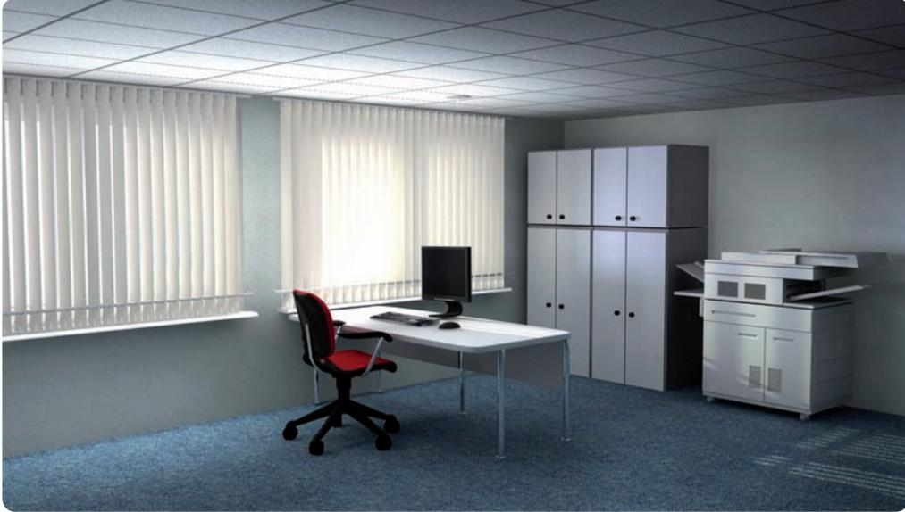
Je nach Abstand des Lichtfühlers vom Fenster, kann das seitlich auf den Lichtfühler fallende Licht den eigentlichen Messwert des Lichtfühlers, der sich aus der Beleuchtungsstärke in seinem Erfassungsbereich ergibt, stark verfälschen. Der Lichtfühler hat zwar eine ausgeprägte Richtcharakteristik. Wenn aber die Beleuchtungsstärke des seitlich auf ihn fallenden Lichts um Faktoren höher ist als die Leuchtstärke in seinem Erfassungsbereich, dann ist diese Richtcharakteristik nicht mehr ausreichend.
