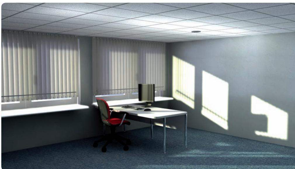
In diesem Bild sieht man deutlich die stark reflektierenden weißen Fensterbänke im Erfassungsbereich des Lichtfühlers, der nur etwa zwei Meter von den Fenstern entfernt montiert ist.
