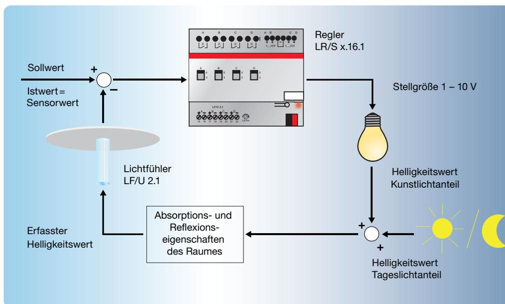
Diesen Messwert (Istwert) vergleicht er mit dem vorgegebenen Sollwert und führt die Stellgröße so nach, dass die Abweichung zwischen Soll- und Istwert minimal wird. Wird es draußen heller, dann wird der Anteil des Kunstlichtes reduziert. Wird es draußen dunkler, wird der Anteil des Kunstlichtes erhöht. Die genaue Funktion des Lichtreglers selbst ist in dem Handbuch des Lichtreglers LR/Sx.16.1 im Detail beschrieben.
