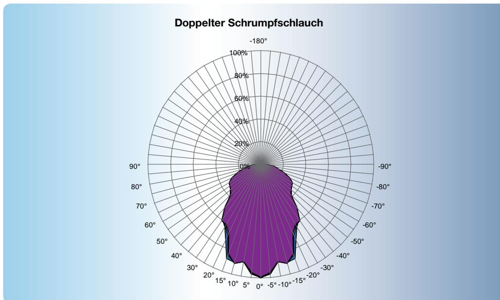
Bei Verwendung einer dieser Stäbe werden Beeinflussungen durch seitlich einfallendes Licht deutlich reduziert. Weiterhin ist die Regelung empfindlicher auf Veränderungen im Erfassungsbereich des Lichtfühlers, z. B. das Auswechseln einer dunklen Schreibtischauflage durch eine helle.
