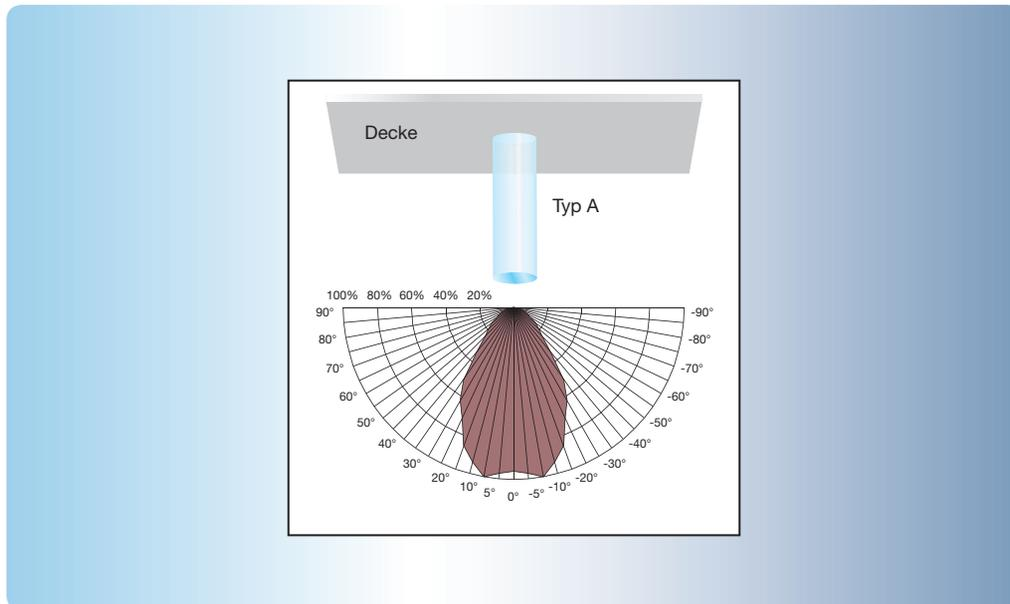
Wie aus dem obigen Bild ersichtlich ist, liegt der 3-dB-Öffnungswinkel des bisher verfügbaren Lichtfühlers LF/U 1.1 bei etwa 60°.
