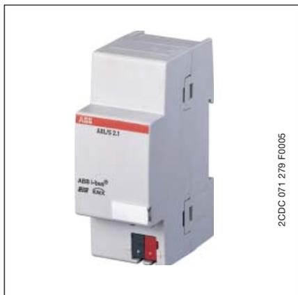
Der Applikationsbaustein Logik ist ein Reiheneinbaugerät zum Einbau in den Verteiler. Das Gerät enthält logische Funktionen mit der Möglichkeit Parameter individuell zu parametrieren. Des Weiteren stehen Zeitglieder mit Ein-/Ausschaltverzögerung und Impulsdauer, Treppenlichtfunktionen und Vergleicher zur Verfügung.
