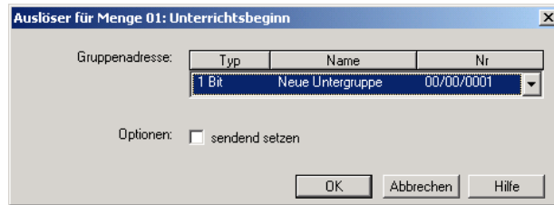
Abb. 168: Parameterfenster „Mengenauslöser, Gruppenadresse eingefügt“
